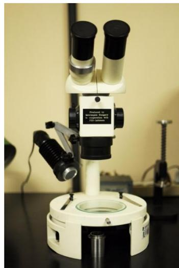
**Figura 32:** Estereoscópio Studar Lab, produzido por Metrimpex e Labimex, modelo PZ0.
