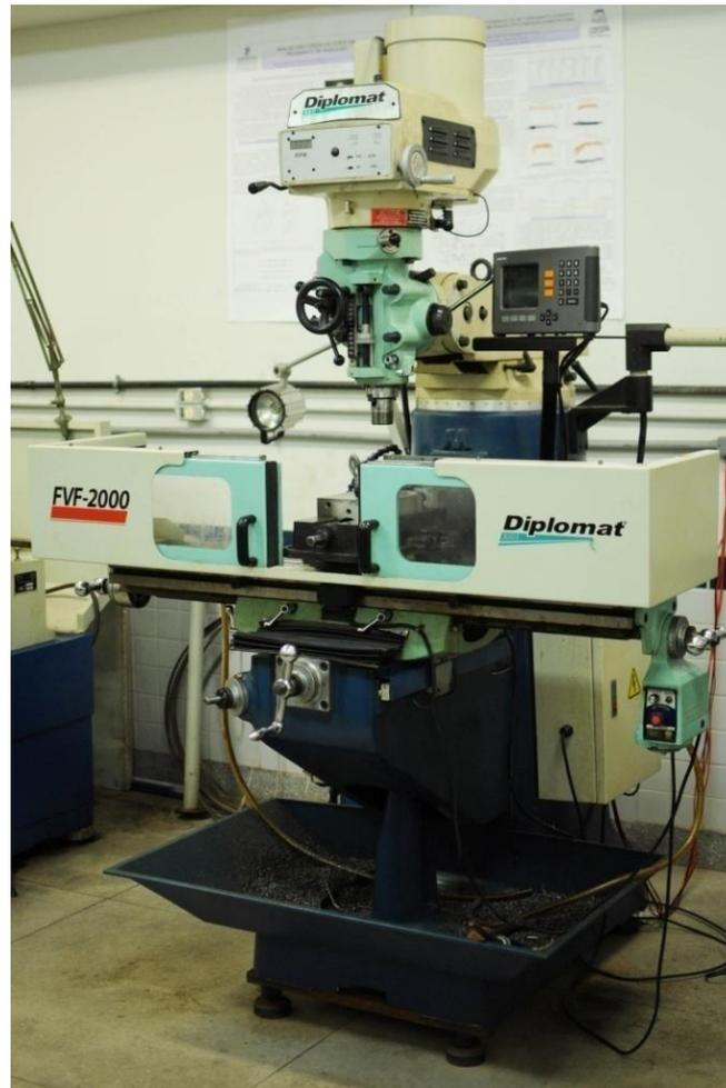
**Figura 30:** Fresadora Diplomat 3001 modelo FVF 2000.
